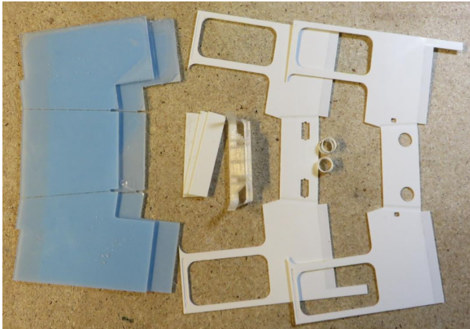
Unterbaugruppe Wagenkasten-Bodenteile [KB]: (Bodenplatten, Abdeckplatten, Gewichte, Einstiege)
