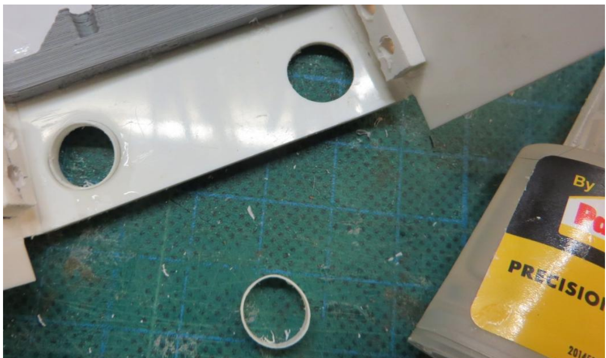
Für den Großteil der Frontschweinwerfer werden die dargestellten Kunststoffringe als Frontscheinferrahmen verwendet. Zum einkleben wird das Frontteil wie dargestellt auf dem Tisch gelegt. Dann wird der Ring so in das Frontteil eingesetzt, dass die Unterkante des Ringes bündig mit der Innenseite vom Frontteil abschließt. Der Winkel, der dabei entstehen sollte liegt genau zwischen der Ebene die rechtwinkelig zum Boden des Modells verläuft und der Ebene die parallel zur Frontwand liegt (siehe nächste Abbildung).
